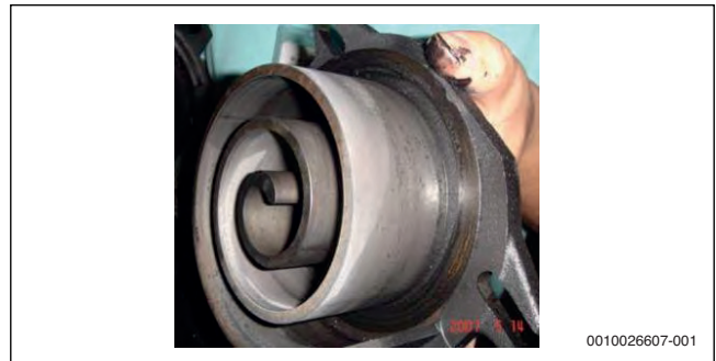
Рис. 73 Изношенная пластина прокрутки
