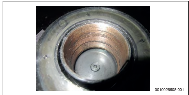
Рис. 74 Изношенная пластина прокрутки
