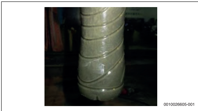
Рис. 71 Мутное или серое масло как признак неправильной работы системы
