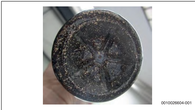
Рис. 70 Масло, содержащее частицы меди
